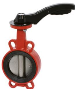
Costruzione in ghisa sferoidale EN-GJS-400-15, disco in acciaio inox AISI 316, sede in EPDM, comando manuale a leva sino al DN 200, oltre tramite riduttore di manovra a volantino, idonea per essere inserita tra flange UNI PN 10/16 e ANSI 150.
