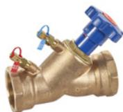
Costruzione in bronzo, interni in ottone, otturatore con tenuta morbida in PTFE, con prese di pressione a innesto rapido, attacchi filettati GAS F/F.
