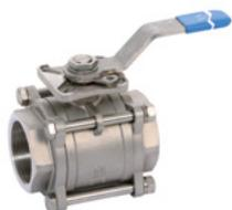
Costruzione in acciaio inox AISI 316, sfera in acciaio inox AISI 316, sedi di tenuta in PTFE, attacchi filettati GAS F/F o a saldare SW.
