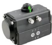
Attuatore pneumatico con corpo in alluminio con versioni a doppio e semplice effetto con molle di ritorno. Dotato, come standard, di un indicatore superiore multi funzione open-closed e della regolazione dell'apertura/chiusura. Tutti gli attuatori sono certificati SIL (in conformità alla normativa IEC 61508:2010), e sono altresì conformi alla Direttiva ATEX 2014/34/UE.
