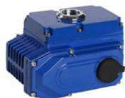
Attuatore elettrico IP 67 con chiave per manovra d'emergenza, costruito in alluminio pressofuso con ingranaggi in acciaio e vite senza fine in bronzo. Garantisce elevate prestazioni e affidabilità nel tempo. Brand: AOX
