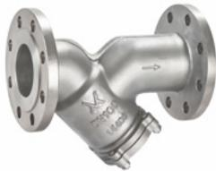
Costruzione in acciaio inox GX5 CrNiMo 19-11-2, cestello estraibile in tela metallica di acciaio inox AISI 316, tappo di spurgo sul coperchio. Codice: 0500IKDN06
