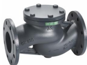
Costruzione in ghisa sferoidale EN-GJS-400-18-LT, interni in acciaio inox, munita di molla per funzionamento anche in posizione verticale. Codice: 0056/DN
