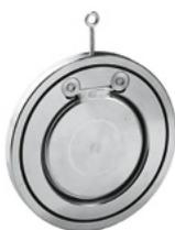
Costruzione in acciaio al carbonio ASTM A105, guarnizioni in gomma NBR, idonea per essere inserita tra flange UNI PN 10/16/ANSI 150. Codice: 0376EKDN0404
