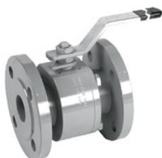
Costruzione in acciaio al carbonio ASTM A105, sfera in acciaio inox AISI 304, sedi di tenuta in PTFE, attacchi flangiati UNI PN 16.
