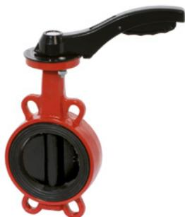
Costruzione in ghisa sferoidale EN-GJS-400-15, disco in ghisa sferoidale rivestito poliestere, sede in EPDM, comando manuale a leva sino al DN 200, oltre tramite riduttore di manovra a volantino, idonea per essere inserita tra flange UNI PN 10/16 e ANSI 150.
