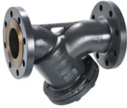
Costruzione in acciaio al carbonio 1.0619, cestello estraibile in lamiera forata di acciaio inox AISI 304, tappo di spurgo sul coperchio. Codice: 0500EKDN04
