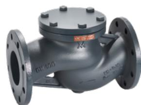
Costruzione in ghisa sferoidale EN-GJS-400-18-LT, interni in acciaio inox, munita di molla per funzionamento anche in posizione verticale. Codice: 0057/DN
