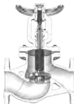
Otturatore semiautomatico con funzione di valvola di ritegno e chiusura SDNR Automatic disc with function of check and on/off valve
