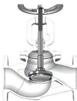
Otturatore a profilo parabolico di regolazione a tenuta morbida di PTFE intercambiabile Regulating disc with soft sealing interchangeable PTFE disc
